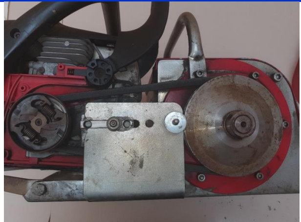
Rys. 59. Wciągarka linowa Husqvarna z napędem od silnika pilarki spalinowej Jonsered CS 2240 – widok na układ przeniesienia napędu na bęben linowy
