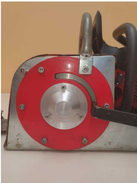
Rys. 60. Wciągarka linowa Husqvarna z napędem od silnika pilarki spalinowej Jonsered CS 2240 – widok na osłonę sprzęgła ciernego napędu bębna linowego i szczelinę prowadzącą dźwigni tego sprzęgła w pozycji poziomej
