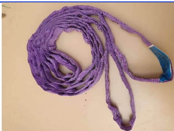
Rys. 49. Lina pomocnicza (kotwicząca) do przewijarki kabestanowej Portable Winch PCW 300 700 kg
