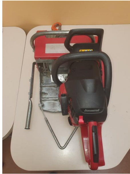
Rys. 57. Wciągarka linowa Husqvarna z napędem od silnika pilarki spalinowej Jonsered CS 2240 – widok z góry
