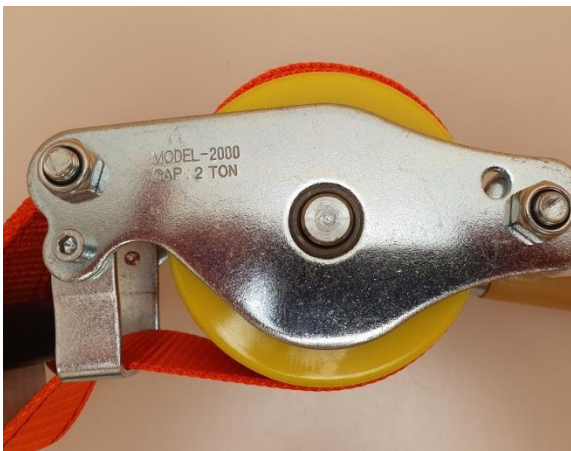
Rys. 76. Naciągarka L-97/1500 – widok z lewej/prawej strony na mechanizm zwalniający i wybity model i siłę uciągu
