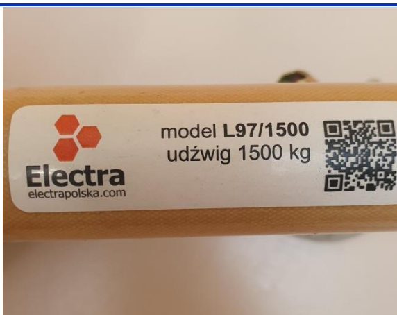
Rys. 78. Naciągarka L-97/1500 – naklejone oznaczenie na drążku
