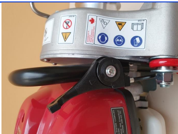
Rys. 48. Dźwignia (manetka) regulacji prędkości obrotowej silnika przewijarki kabestanowej Portable Winch PCW 300 700 kg
