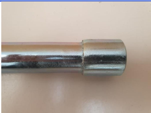
Rys. 16. Kołnierz wzmacniający końcówki osadzonej drążka o stałej długości
