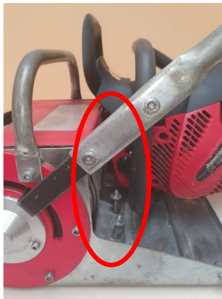
Rys. 65. Zabezpieczenie podatne ruchomej osłony tylnej bębna linowego wciągarki linowej Husqvarna z napędem od silnika pilarki spalinowej Jonsered CS 224
