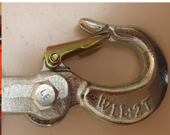
Rys. 81. Hak zaczepowy naciagarki L-97/1500 z wybitym obciążeniem roboczym
