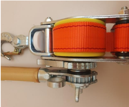
Rys. 74. Naciągarka L-97/1500 – widok z góry/dołu na mechanizm zapadkowy i pas nawinięty na bęben
