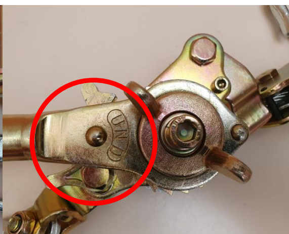
Rys. 69. Naciągarka YT-5914 – widok z prawej/lewej strony na mechanizm zwalniający i wybite oznaczenie producenta
