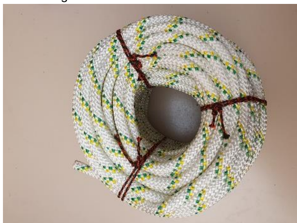
Rys. 51. Lina główna (robocza) – zabezpieczona przed rozwinięciem do przewijarki kabestanowej Portable Winch PCW 300 700 kg – widok z góry
