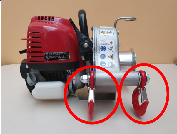
Rys. 30. Przewijarka kabestanowa Portable Winch PCW 300 700 kg – widok z prawej strony (widoczne haki do zamocowanie liny pomocniczej – kotwiczącej)
