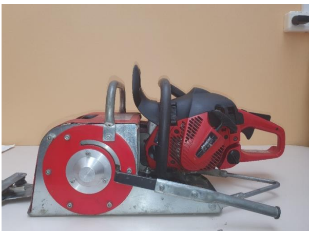
Rys. 60. Wciągarka linowa Husqvarna z napędem od silnika pilarki spalinowej Jonsered CS 2240 – widok na osłonę sprzęgła ciernego napędu bębna linowego i szczelinę prowadzącą dźwigni tego sprzęgła w pozycji poziomej
