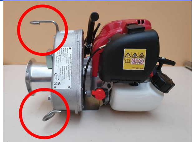
Rys. 31. Przewijarka kabestanowa Portable Winch PCW 300 700 kg – widok z lewej strony (widoczne przewodniki liny głównej – roboczej)
