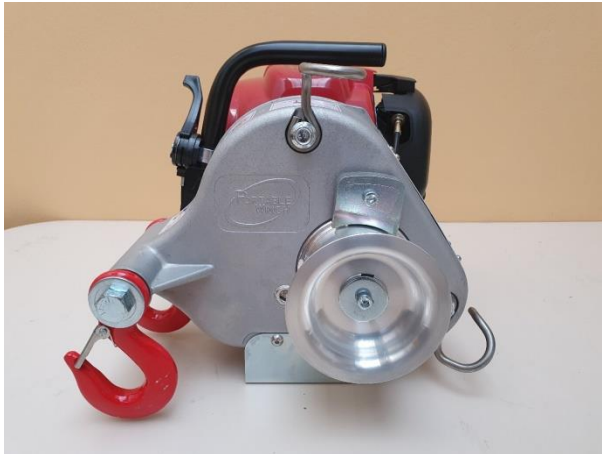
Rys. 32. Przewijarka kabestanowa Portable Winch PCW 300 700 kg – widok z przodu (od strony bębna)
