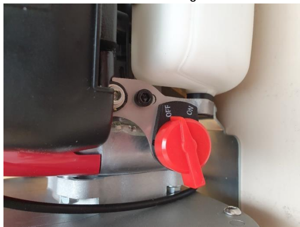
Rys. 47. Włącznik/wyłącznik zapłonu silnika przewijarki kabestanowej Portable Winch PCW 300 700 kg
