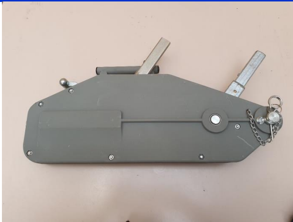
Rys. 18. Przeciągarka (urządzenie główne) Nordforest 1600 kg – widok z lewej strony
