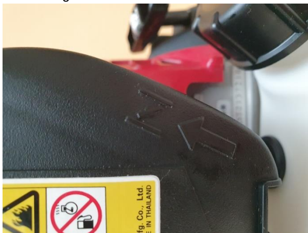
Rys. 46. Grafika informacyjna dźwigni ssania silnika przewijarki kabestanowej Portable Winch PCW 300 700 kg
