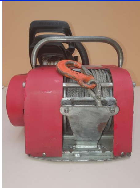
Rys. 55. Wciągarka linowa Husqvarna z napędem od silnika pilarki spalinowej Jonsered CS 2240 – widok z przodu (od strony bębna z nawiniętą liną zakończoną hakiem i podniesioną dwurołkową prowadnicą liny)
