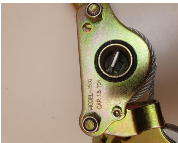
Rys. 70. Naciągarka YT-5914 – widok z lewej/prawej strony na mechanizm zwalniający i wybity model i siłę uciągu
