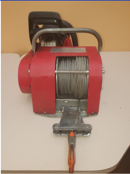
Rys. 54. Wciągarka linowa Husqvarna z napędem od silnika pilarki spalinowej Jonsered CS 2240 – widok z przodu (od strony bębna z nawiniętą liną zakończoną hakiem i opuszczoną dwurołkową prowadnicą liny)
