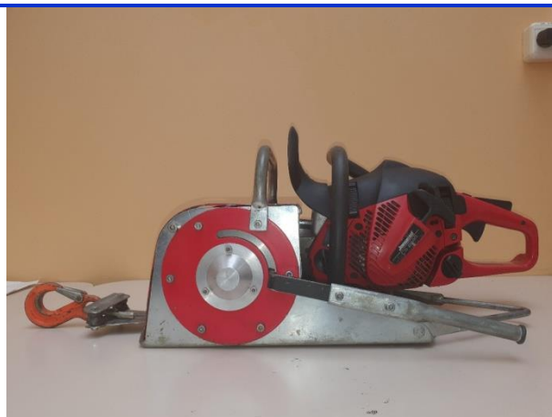
Rys. 53. Wciągarka linowa Husqvarna z napędem od silnika pilarki spalinowej Jonsered CS 2240 – widok z lewej strony (widoczna dźwignia i osłona sprzęgła ciernego napędu bębna)
