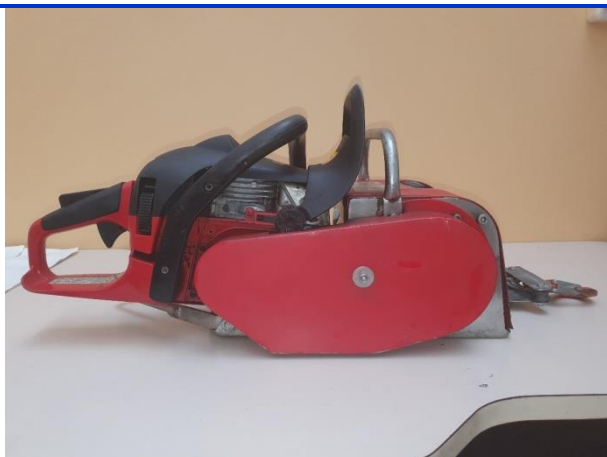
Rys. 52. Wciągarka linowa Husqvarna z napędem od silnika pilarki spalinowej Jonsered CS 2240 – widok z prawej strony (widoczna osłona układu przeniesienia napędu)
