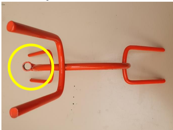
Rys. 26. Szpula liny (widok z przodu) – widoczny pierścień do osadzenia końcówki liny
