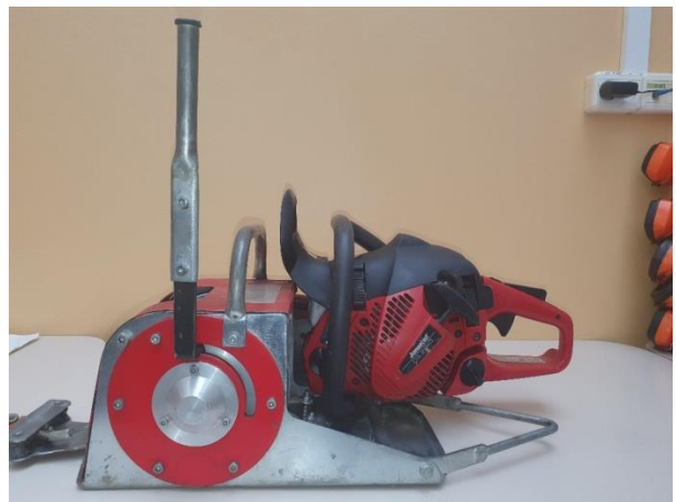
Rys. 61. Wciągarka linowa Husqvarna z napędem od silnika pilarki spalinowej Jonsered CS 2240 – dźwignia sprzęgła ciernego napędu bębna linowego w pozycji pionowej
