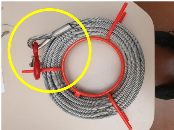
Rys. 28 Lina nawinięta na szpulę – widoczny hak zaczepowy liny
