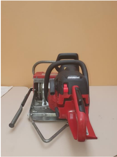
Rys. 56. Wciągarka linowa Husqvarna z napędem od silnika pilarki spalinowej Jonsered CS 2240 – widok z tyłu (od strony uchwyty tylnego pilarki i widocznym uchwytem mocującym linę kotwiczną)
