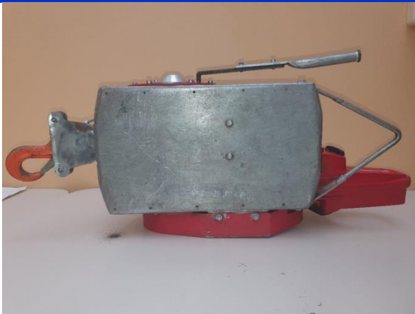
Rys. 58. Wciągarka linowa Husqvarna z napędem od silnika pilarki spalinowej Jonsered CS 2240 – widok z dołu
