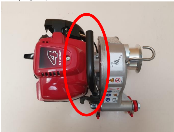
Rys. 34. Przewijarka kabestanowa Portable Winch PCW 300 700 kg – widok z góry (widoczny uchwyt do przenoszenia)
